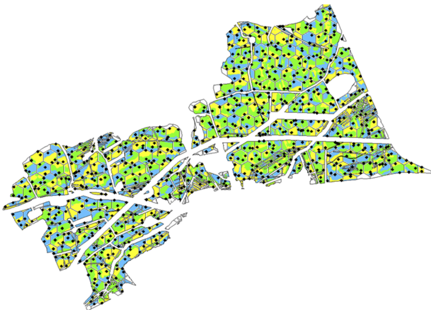
Figure 9: Concept d'échantillonnage H3 final pour Prez. Les hexagones couvrent une surface de 1ha. Trois sites H3 sont sélectionnés par hexagone à l'aide de deux méthodes de regroupement. Les zones colorées en arrière-plan indiquent les surfaces de remplacement associées (trois au maximum) lorsque l'échantillonnage n'est pas possible au point prévu.
