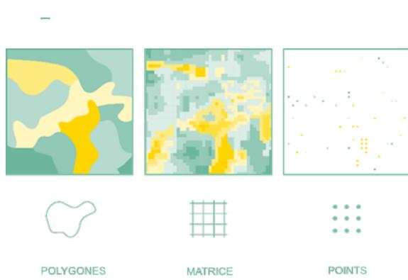
Figure 1 : Produits issus d'une cartographie des sols : données ponctuelles (profils et sondages) et données surfaciques (format vectoriel et matriciel).
