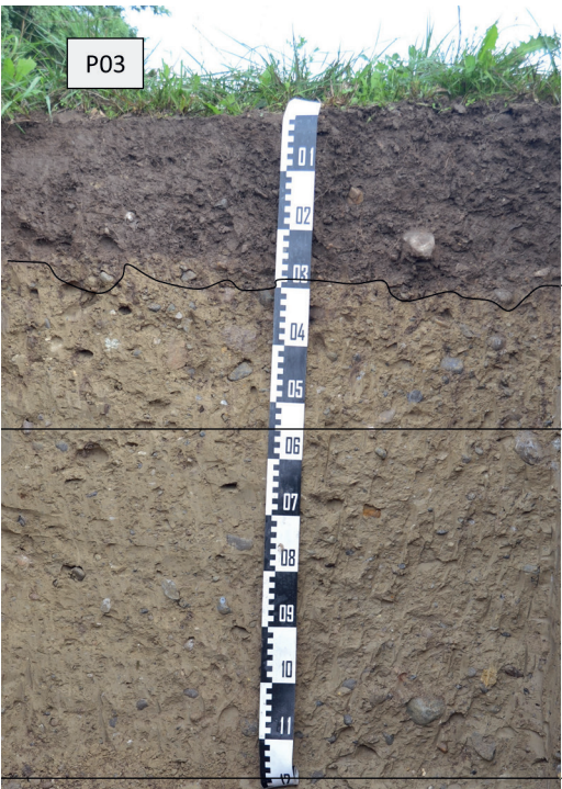
Abbildung 25: Bodenprofil P03 (Regosol). Die Angaben zur Körnung, zum Humus, zum pH-Wert und zum Kalk sind Laboranalysen. Die Skelettgehalte stellen Feldschätzungen dar.
