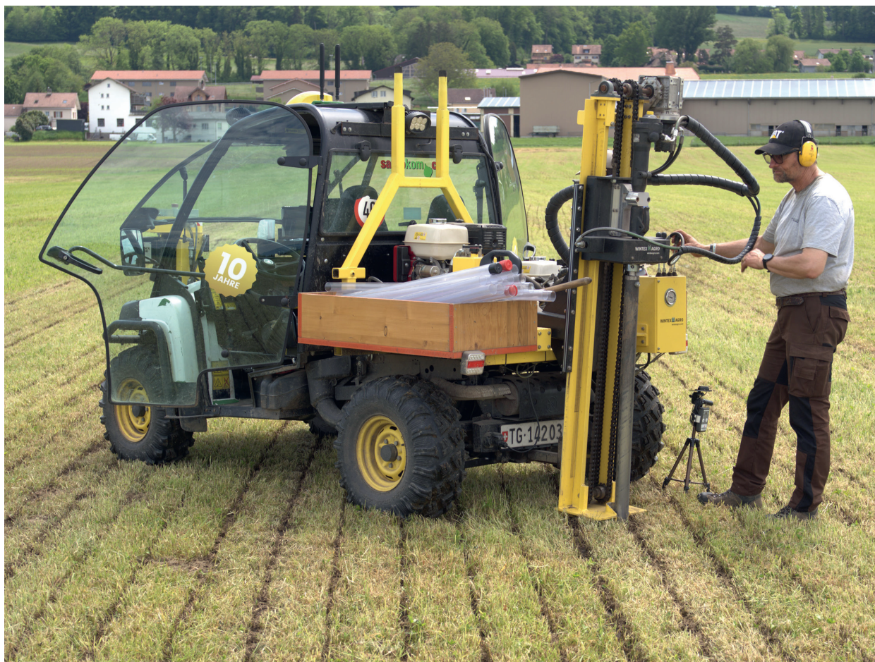
Abbildung 49: Bohrgerät Wintex MCL3 der Firma WintexAgro zur automatisierten Probenahme von Bodenproben.
