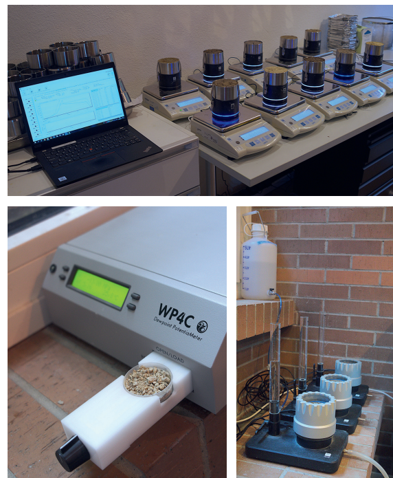
Abbildung 51: Ansicht der HYPROP-Geräte zur Messung der Wasserretentionskurve im «feuchten» Bereich (oben), des WP4C zur Messung im «trockenen» Bereich (unten links) sowie der KSAT-Geräte zur Bestimmung der gesättigten hydraulischen Leitfähigkeit (unten rechts).
