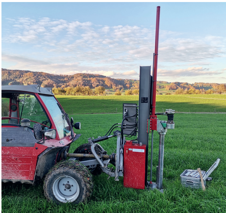
Abbildung 42: Bohrfahrzeug (Aebi TT75) und Bohrturm für die H2-Standorte im Kartierprojekt Lommis (links), sowie die Hülsen, die aufgeschnitten wurden, zur bodenkundlichen Beschreibung und Klassifikation der Böden (rechts).
