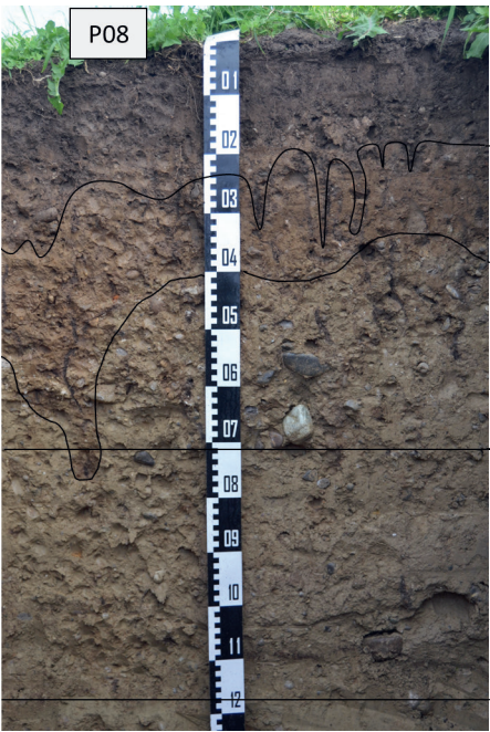
Abbildung 28: Bodenprofil P08 (Kalkbraunerde). Die Angaben zur Körnung, zum Humus, zum pH-Wert und zum Kalk sind Laboranalysen. Die Skelettgehalte stellen Feldschätzungen dar.
