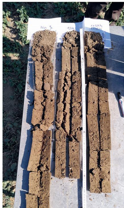
Abbildung 42: Bohrfahrzeug (Aebi TT75) und Bohrturm für die H2-Standorte im Kartierprojekt Lommis (links), sowie die Hülsen, die aufgeschnitten wurden, zur bodenkundlichen Beschreibung und Klassifikation der Böden (rechts).
