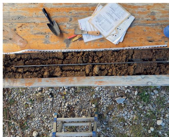
Abbildung 46: H2-Bohrung B71: sehr tiefgründige, grundfeuchte, kolluviale, drainierte Braunerde (pnG 108 cm, Bohrkern 120 cm).
