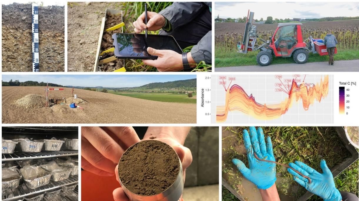
Abbildung 1: Das Bodenprofil mit Massband illustriert den Bodentyp «Regosol» (flachgründiger Boden über Konglomeratgestein); Erfassung von Bodeninformationen mit Hilfe eines Tablets; das KOBO-Bohrfahrzeug vor dem Einsatz; Profil in der Landschaft; Auswertung von Bodenproben im Labor (Spektroskopie); Aufbereitung von Proben im Laborofen; Zylinder für bodenphysikalische Messungen (u. a. Wasserretention) sowie Regenwurmzählungen im Feld (Bilder von oben links nach unten rechts).
