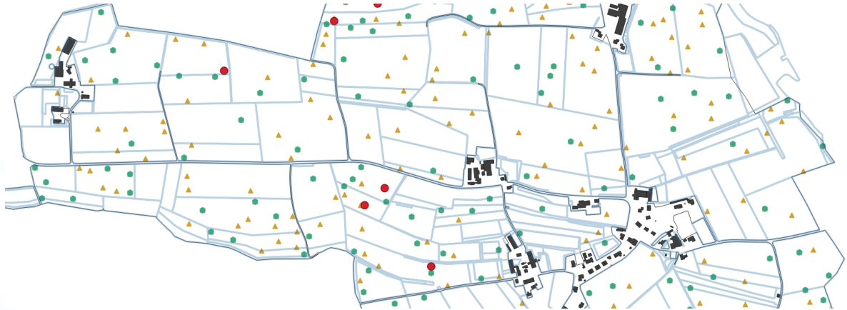
Abbildung 7. Darstellung eines Ausschnitts des Beprobungskonzepts im Pilotprojekt des KOBO in Diemerswil (Keller et al. 2023). Die Hierarchiestufen sind farblich gekennzeichnet. H1 (Bodenprofile): rot; H2 (Bohrungen für pedologische Aufnahmen): grün; H3 (Bohrungen für spektroskopische Messungen im Labor): gelb.
