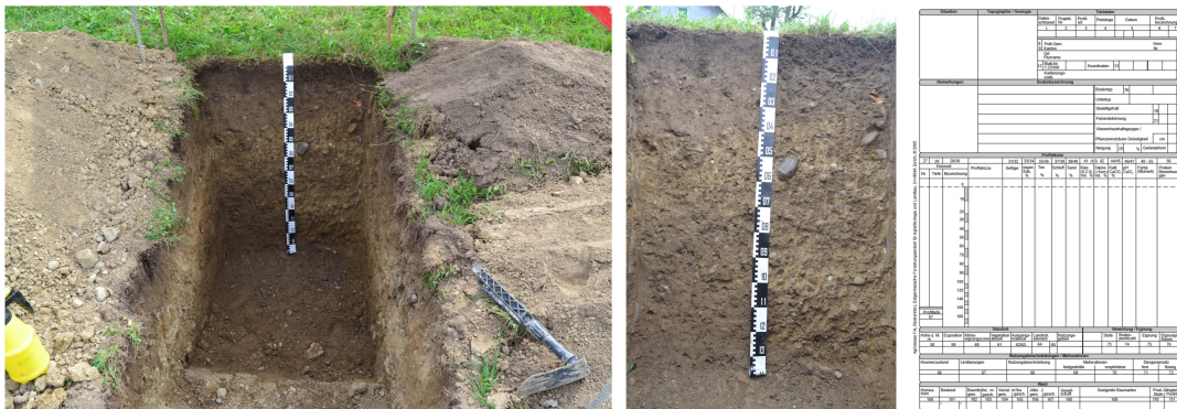
Abbildung 4. Profilgruben (links) ermöglichen einen sicheren Einstieg zum Beprobieren und Beschreiben des Aufbaus und der Eigenschaften von Böden anhand einer senkrechten Profilwand (Mitte). Die Informationen über das Bodenprofil werden in einem standardisierten Profilblatt festgehalten (rechts).
