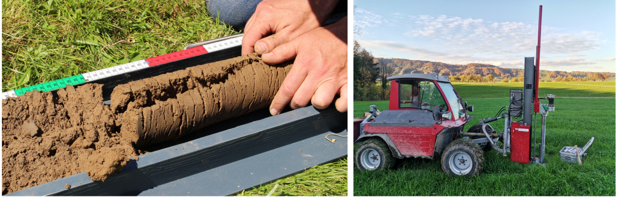
Abbildung 8. An H2-Standorten werden Bohrungen für pedologische Aufnahmen (links) mit einem Bohrfahrzeug (rechts) oder manuell entnommen. An H3-Standorten findet keine bodenkundliche Beschreibung statt, es werden Proben aus verschiedenen Tiefen für Analysen im Labor entnommen. Die Bohrfahrzeuge können mit verschiedenen Bohrsystemen betrieben werden. Im Beispiel auf der rechten Seite ist der Aufsatz für die H2-Bohrungen montiert.
