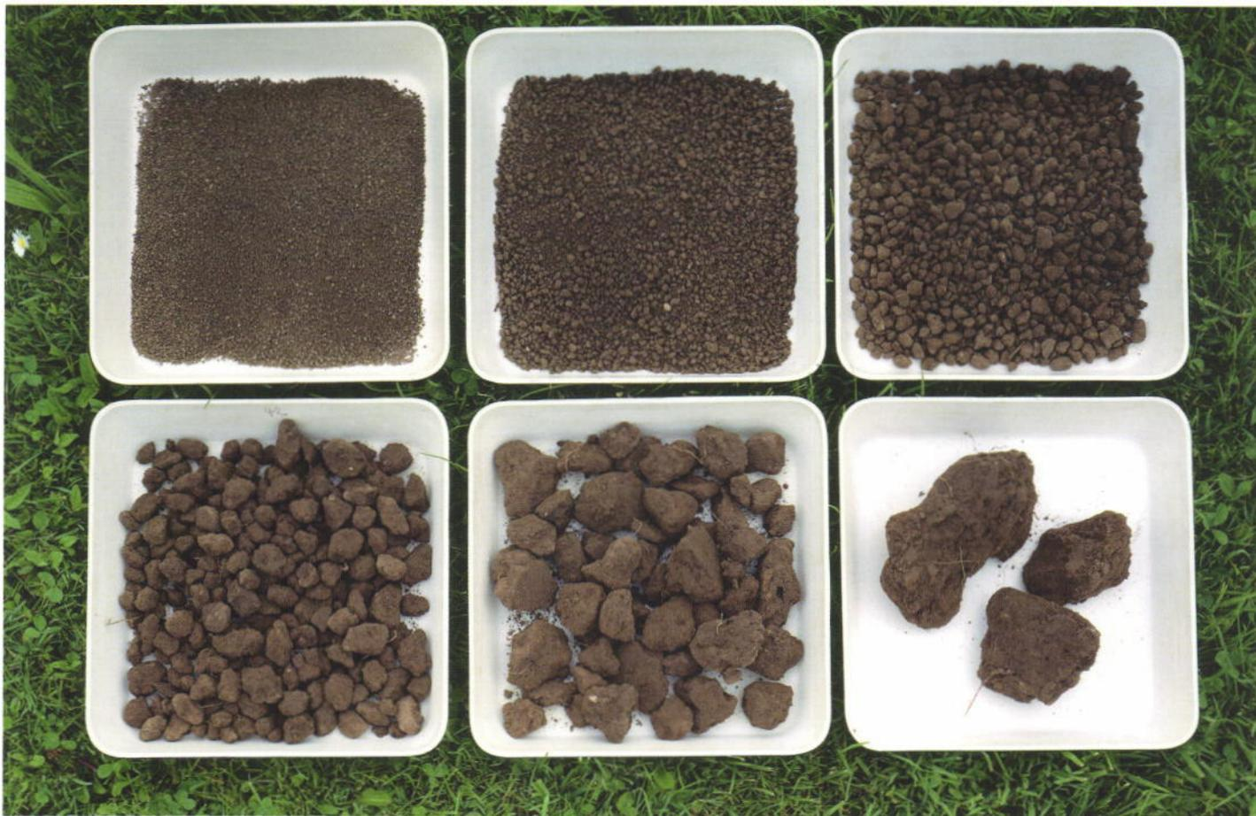
**Figure 3c:** Aperçu visuel du résultat de la méthode appliqué sur un échantillon de sol provenant du horizon Ahp<sup>1</sup> (0 à 12 cm). Le fractionnement a donné six catégories de taille d'u.s. Le sol,
