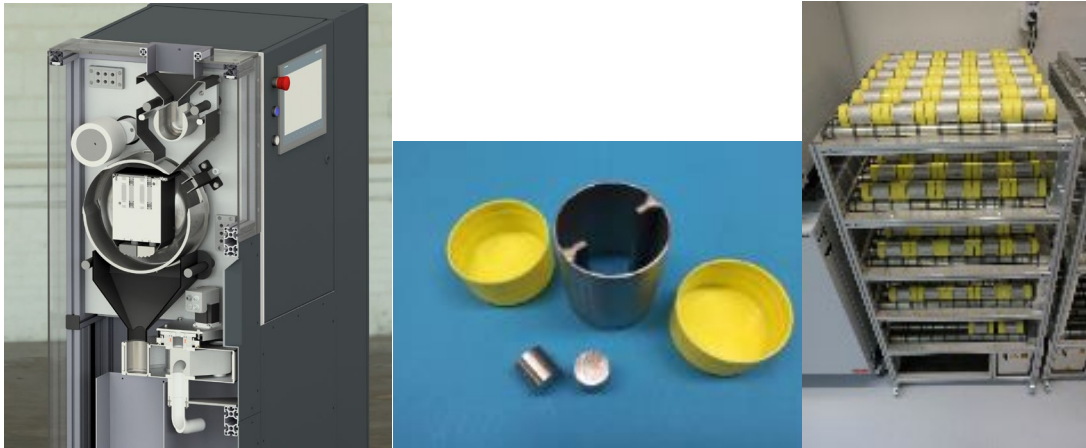
Prototype réalisant une préparation plus rapide des échantillons (à gauche), capsules avec pierres de broyage (au milieu) et système rotatif (à droite).
