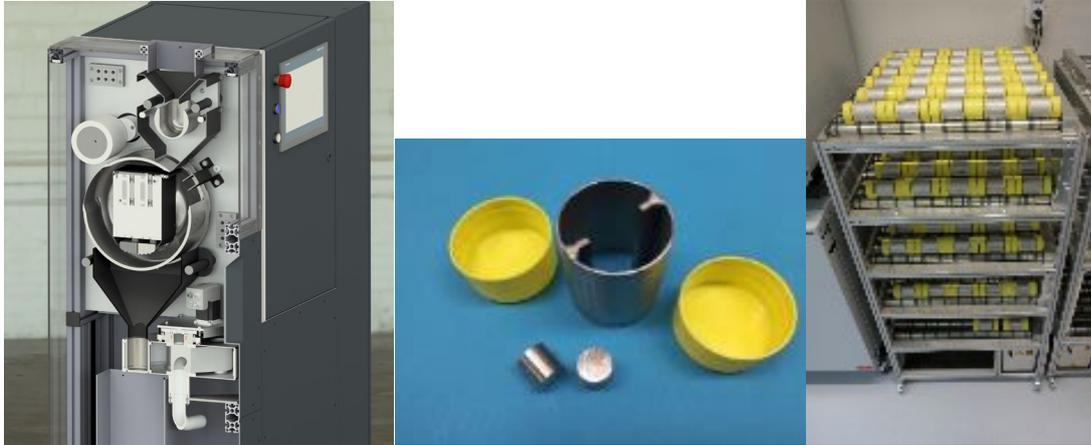
Abbildung : Prototyp für eine schnellere Probenaufbereitung (links), Mahlkapseln mit Mahlsteinen (Mitte) und drehendes System zum Mahlen der Bodenproben (rechts).
