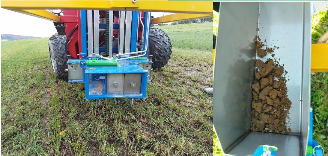
Abbildung: Der Bohrmeißel wird automatisch auf vorgegebene Tiefenstufen in Alubehälter entleert.
