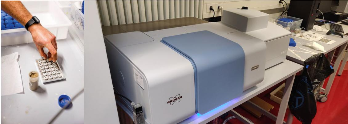
Abbildung: Plates für Autosampler (24 Proben) für Bruker MIR Gerät.
