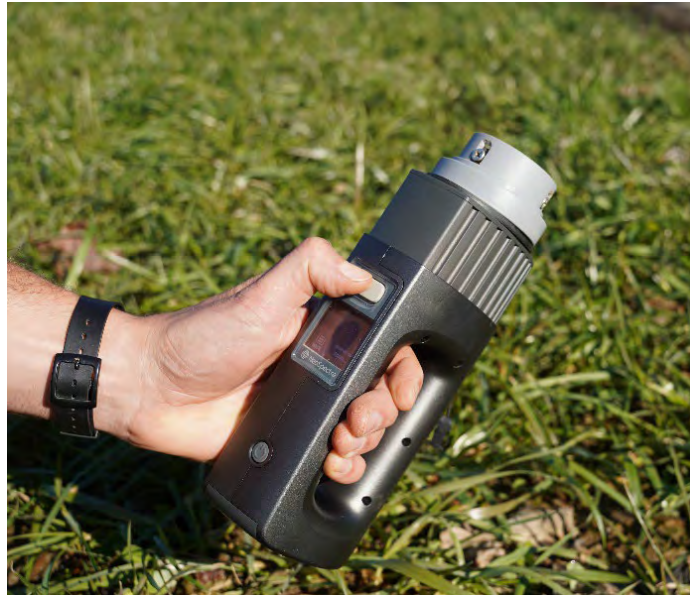
Das Feldinfrarotspektrometer NeoSpectra (unten) mit Aufsatz zur Messung eines Pellets (oben).
