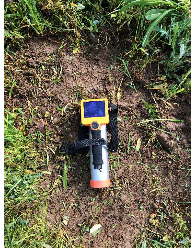
Der Gamma Vario VB6 wird für eine Messung direkt auf den unbedeckten Boden gelegt (Gamma).
