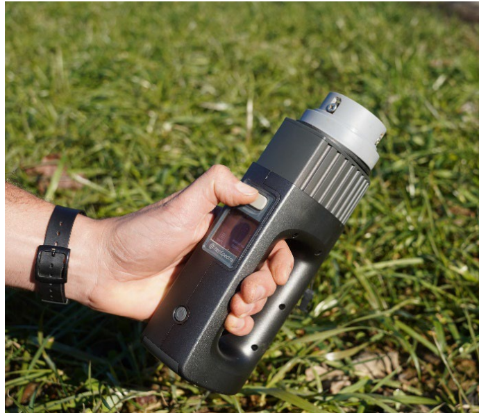
Spectromètre infrarouge de terrain NeoSpectra (en bas) avec son embout pour mesurer une pastille (en haut).
