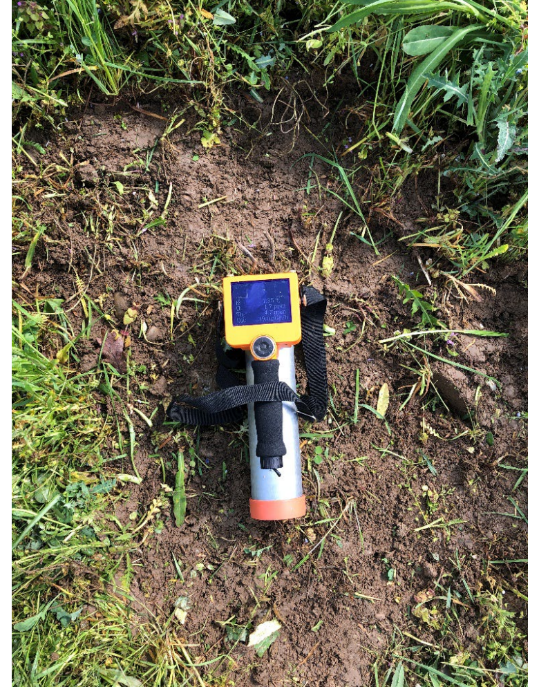
Gamma Vario VB6 mesure directement sur le sol sans couverture végétale (gamma).
