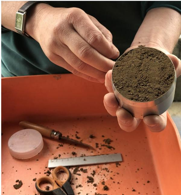
Figure 25 : Cylindres munis d'une surface minutieusement préparée de sorte qu'elle soit la plus plate possible afin de maximiser les contacts.
