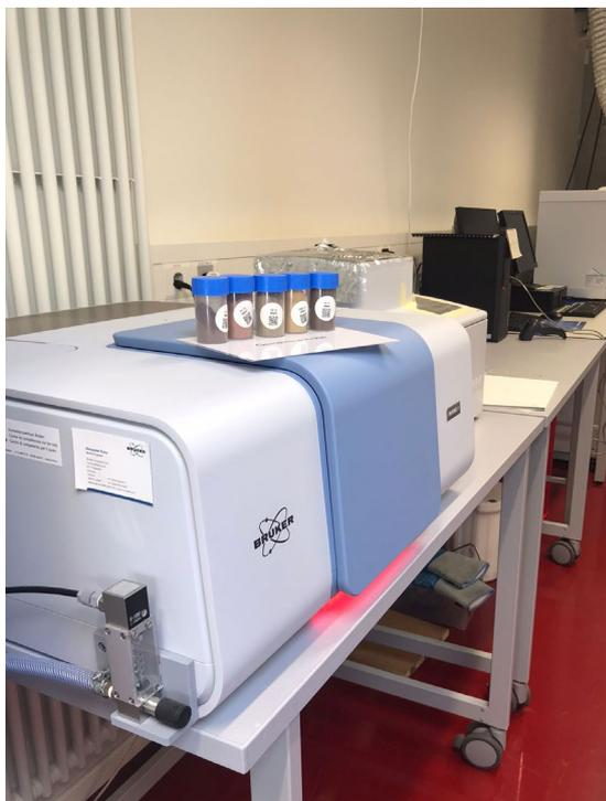
Figure 31 : Bruker INVENIO équipé d'un module à haut débit (HTS-XT).
