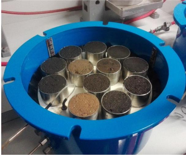
Figure 27 : Installation des échantillons dans la marmite à pression.
