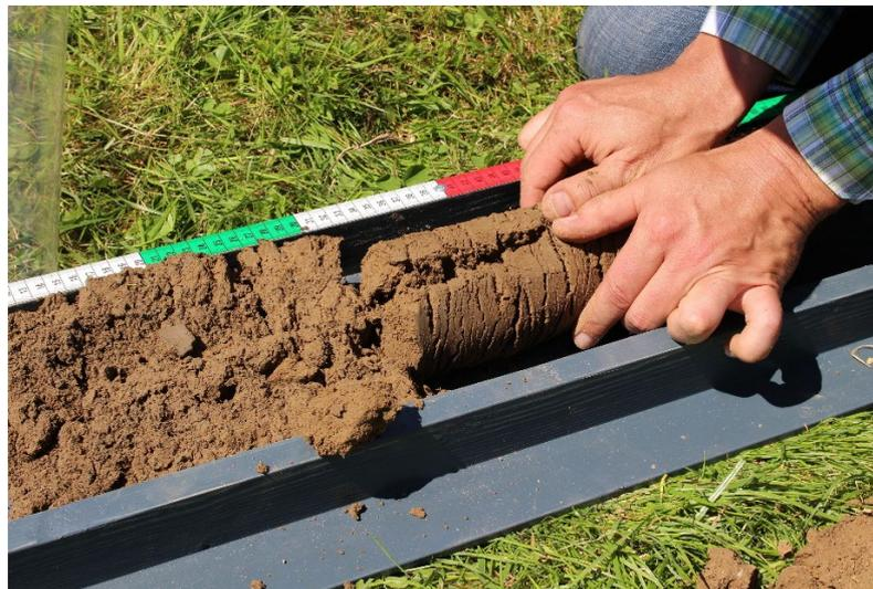
Figure 13 : Préparation de la carotte pour la description pédologique dans une boîte spécialement conçue à cet effet.
