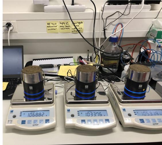
Figure 28 : Echantillon en cours d'analyse sur le HYPROP.
