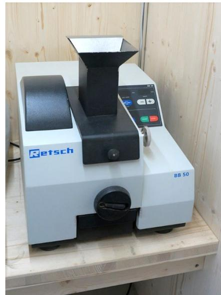
Figure 20 : Tri manuel de l'échantillon de sol fraîchement prélevé sur le terrain. Figure 21 : Concasseur à mâchoires permettant de broyer les agrégats.
