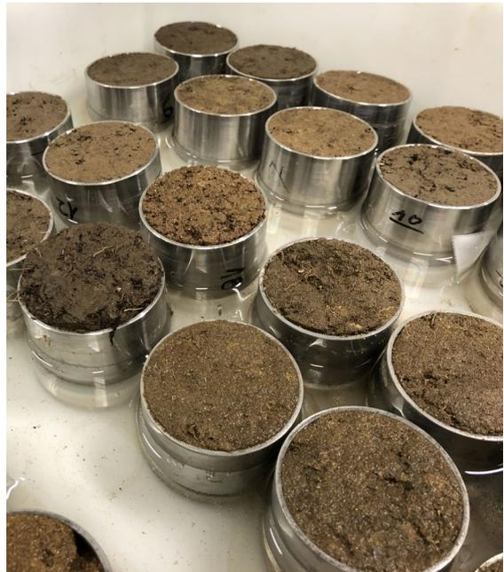
Figure 26 : Phase de saturation en eau des cylindres avant leur passage dans la marmite à pression ou le HYPROP.
