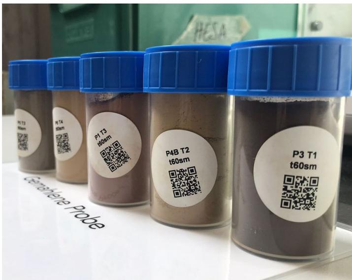
Figure 23 : Stade final de la préparation des échantillons : flacons en plastique contenant les échantillons pédologiques finement broyés (<100mm).
