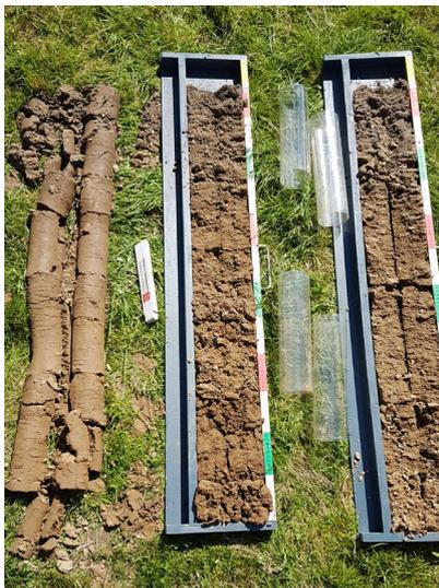
Figure 12 : Sondages prélevés à l'aide du véhicule de sondage. Le matériel a été sorti de la cartouche et préparé.
