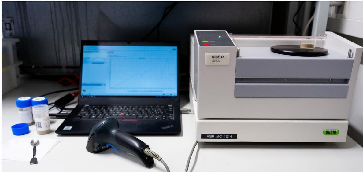
Figure 30 : Büchi NIRFlex-N500 spectromètre infrarouge proche (NIR) avec ustensiles de mesure et ordinateur portable.
