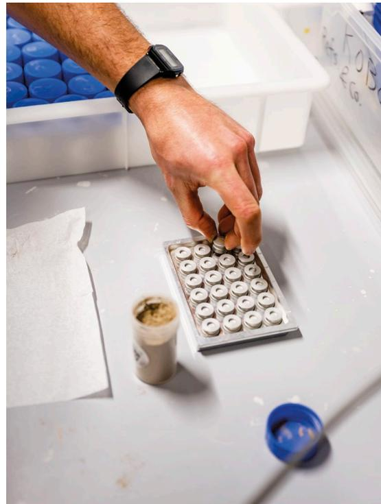
Figure 32 : Remplissage de la plaque de mesure multi-échantillon avant la mesure MIR (© Susanne Goldschmid/OFEV).
