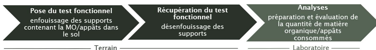
Figure 18 : Principe méthodologique de base pour les méthodes fonctionnelles.
