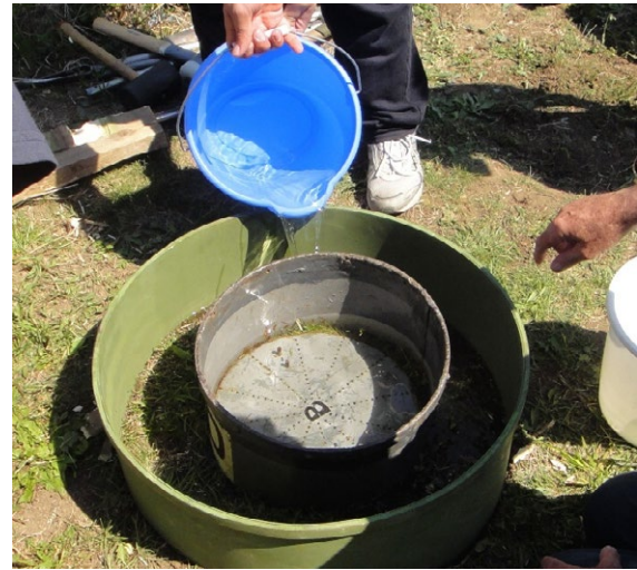
Figure 22 : Infiltrromètre à double anneau en cours d'utilisation pour déterminer le taux d'infiltration. Source de l'illustration : avec l'aimable autorisation de Bářková, K., Matula, S. und Miháliková, M., Faculty of Agrobiolgy, Food and Natural Resources, Czech University of Life Sciences Prague.
