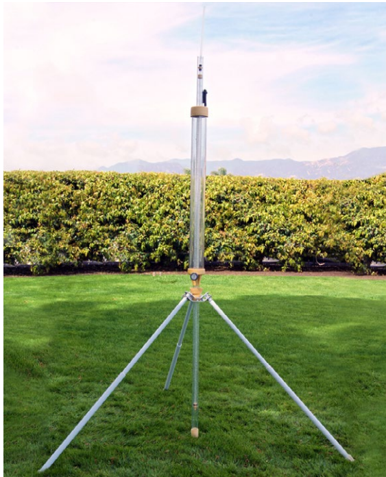
Figure 25 : Perméamètre de Guelph disponible dans le commerce pour mesurer le taux d'infiltration dans le sol. Source de l'illustration : avec l'aimable autorisation de Soilmoisture Corp.
