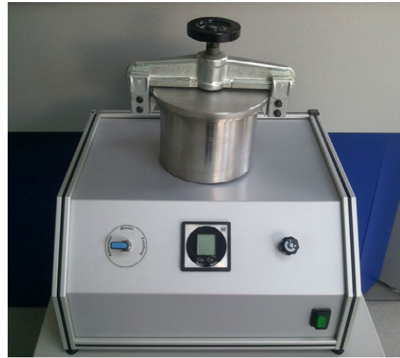
Figure 8: Pycnomètre à air servant à déterminer la matière solide d'un échantillon de sol. Des échantillons de sol structurellement non perturbés sont nécessaires. Source de l'illustration : avec l'aimable autorisation de UGT GmbH.
