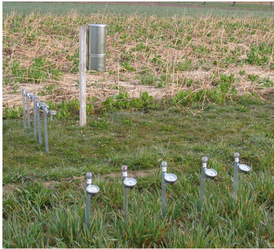
Figure 27 : Tensiomètres installés en permanence dans un champ pour mesurer la force de succion dans le cadre de l'essai à long terme d'Oberacker, dans le canton de Berne. Source de l'illustration : avec l'aimable autorisation de Lorenz Ramseier, LANAT, service de protection des sols du canton de Berne.
