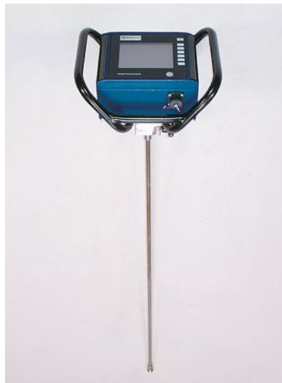
Figure 36 : Pénétromètre statique, disponible sur le marché, permet de déterminer la résistance à la pénétration du sol. Source de l'illustration : avec l'aimable autorisation de UGT GmbH.
