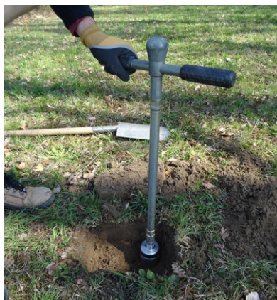
Figure 2: Enfoncement dans le sol de la sonde à percussion munie d'un cylindre pour le prélèvement d'un échantillon de sol non perturbé. Source: avec l'aimable autorisation du groupe de recherche Utilisation et protection des sols de la BFH-HAFL.
