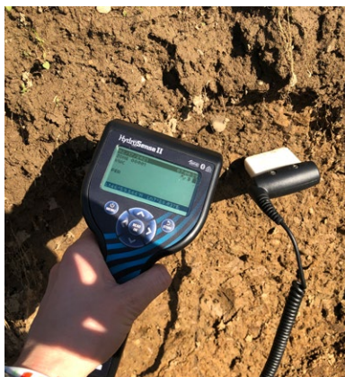
Figure 31 : Utilisation d'une sonde TDR depuis la surface du sol pour mesurer la teneur en eau volumétrique Source de l'illustration: CCSols.
