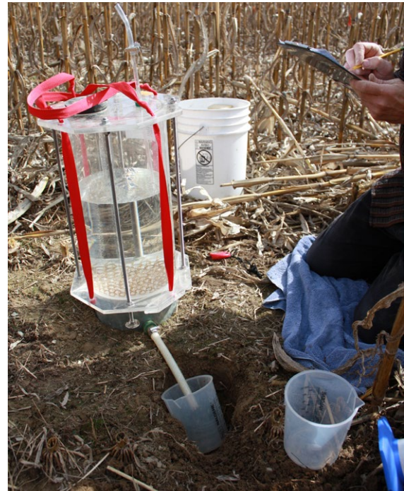
Figure 26 : Infiltromètre à aspersion de Cornell («Cornell sprinkle infiltrometer») installé dans un champ de maïs. Dans cette méthode, le taux d'infiltration est calculé en tant que différence entre le volume des précipitations et le taux de ruissellement de surface mesuré. Source de l'illustration : avec l'aimable autorisation de Cornell Soil Health Staff.
