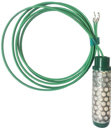
Figure 29 : Capteur d'humidité du sol watermark disponible dans le commerce, constitué de deux électrodes intégrées dans du gypse et entouré d'une enveloppe perforée. Source de l'illustration : avec l'aimable autorisation de Royal Eijkelkamp.
