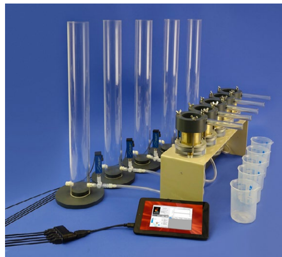
Figure 20 : Appareil de mesure simultanée de la conductivité hydraulique à saturation sur cinq cylindres d'échantillons de sol non perturbé. Le même dispositif permet d'utiliser aussi bien la méthode de la «charge variable» que celle de la «charge constante» (en plaçant une hausse sur les cylindres en plastique). Source de l'illustration : avec l'aimable autorisation de Soilmoisture Corp.
