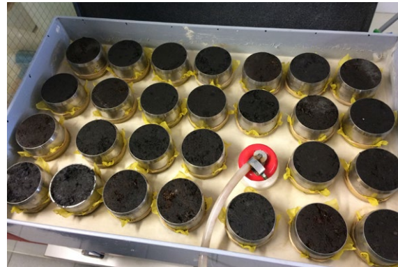
Figure 11 : Vue intérieure d'une boîte à sable avec des échantillons en cylindres de sol structurellement non perturbé. Dans un premier temps, les échantillons sont saturés en eau. Ils sont ensuite soumis à des forces de succion croissantes, et dès qu'un équilibre s'est établi à une force de succion donnée, ils sont pesés. Avec le poids sec et la densité connue de l'eau, qui dépend de la température, il est possible de calculer le volume de classes de pores déterminées. La boîte à sable convient pour le domaine des pores grossiers. Source de l'illustration : Avec l'aimable autorisation du groupe de recherche Utilisation et protection des sols de la BFH-HAFL.
