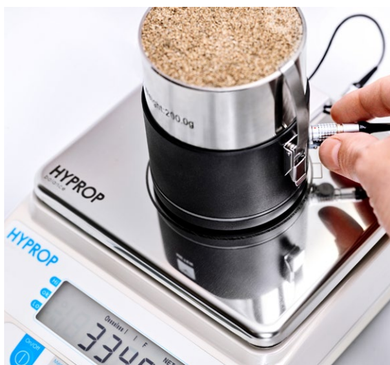
Figure 14 : Dispositif Hyprop 2 pour la mesure du volume de pores dans la plage de force de succion de 0–820 hPa (toute la plage des pores grossiers jusqu'aux pores moyens supérieurs). L'Hyprop 2 permet de mesurer simultanément la courbe de désorption dans la plage de force de succion indiquée ainsi que la conductivité hydraulique non saturée sur des échantillons de sol structurellement non perturbés.
