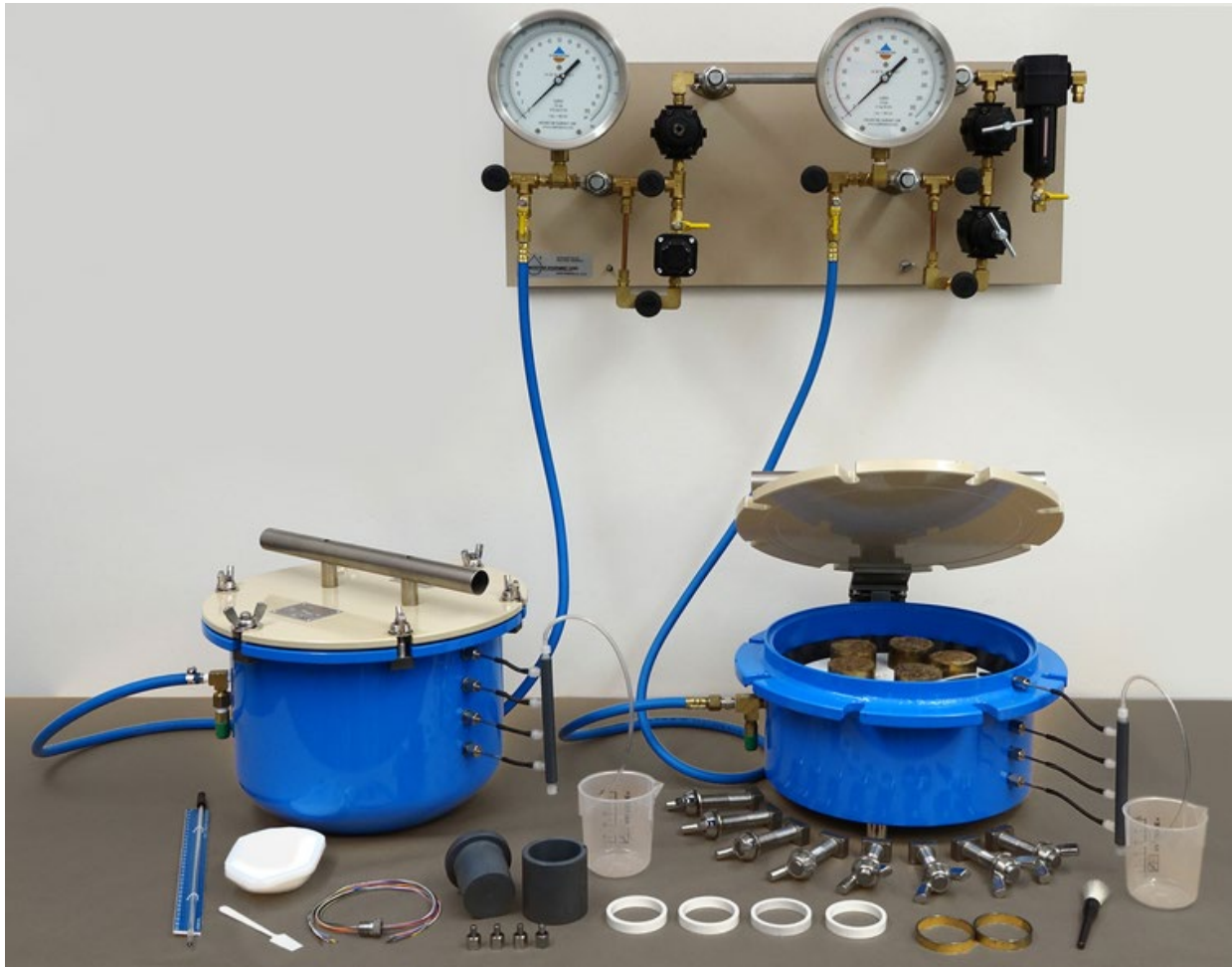
Figure 12 : Marmite à pression du commerce utilisée comme appareil de surpression pour déterminer le volume des pores dans les plages de pF élevées, c'est-à-dire pour les pores moyens et fins. Source de l'illustration : avec l'aimable autorisation de UGT GmbH.
