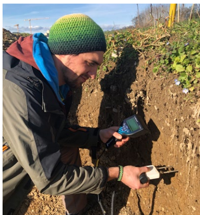
Figure 30 : Utilisation d'une sonde TDR sur la paroi d'un profil pour mesurer la teneur en eau volumétrique Source de l'illustration: CCSols.
