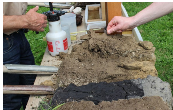
Figure 40 : Échantillons prélevés à la bêche en vue de l'évaluation visuelle de la structure du sol sur le terrain. Source de l'illustration : CCSols.
