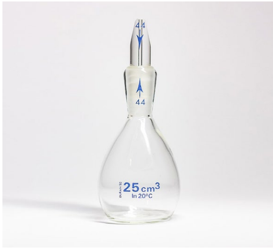
Figure 7: Pycnomètre à eau, disponible dans le commerce, utilisé pour la détermination de la masse volumique de corps solides. Il n'est pas nécessaire de disposer d'échantillons de sol non perturbés. Source de l'illustration : Wikimedia Commons.
