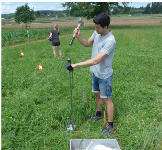
Figure 35 : La sonde Panda est un exemple de pénétromètre dynamique utilisé pour déterminer la résistance à la pénétration du sol. Source de l'illustration : avec l'aimable autorisation de l'Observatoire national des sols, NABO.
