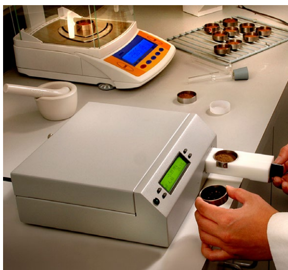
Figure 15 : Le WP4C-Dew Point Meter permet de déterminer les pores fins dans la plage de mesure de pF 3,5 – 6,2. Il n'est pas nécessaire de disposer d'échantillons de sol non perturbés. Source de l'illustration : avec l'aimable autorisation de METER Group.
