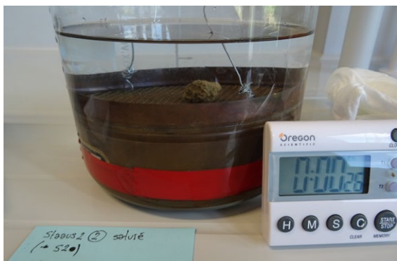
Figure 38 : Déplacement des agrégats du sol sur un tamis placé dans un récipient d'eau dans le but de déterminer la stabilité des agrégats. Source de l'illustration : avec l'aimable autorisation du groupe de recherche Utilisation et protection des sols de la BFH-HAFL.
