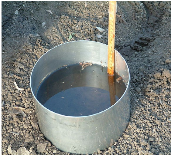
Figure 21 : Infiltrromètre à anneau unique utilisé pour déterminer le taux d'infiltration dans le sol. Source de l'illustration : Wikimedia Commons.
