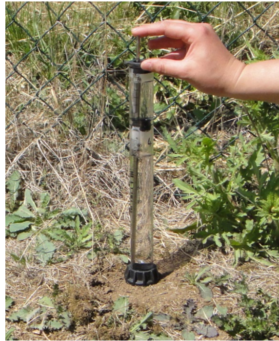
Figure 24 : L'infiltromètre à mini-disque pour la détermination du taux d'infiltration est un infiltromètre à tension prédéfinie pratique, qui peut être utilisé par une seule personne.
