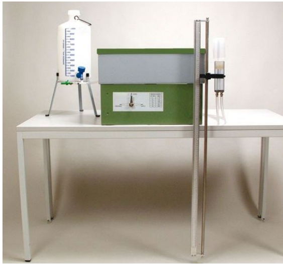
Figure 10 : Boîte à sable («sandbox») disponible dans le commerce en tant qu'appareil à dépression pour déterminer le volume des pores grossiers d'un échantillon de sol. Source de l'illustration : avec l'aimable autorisation de Royal Eijkelkamp.
