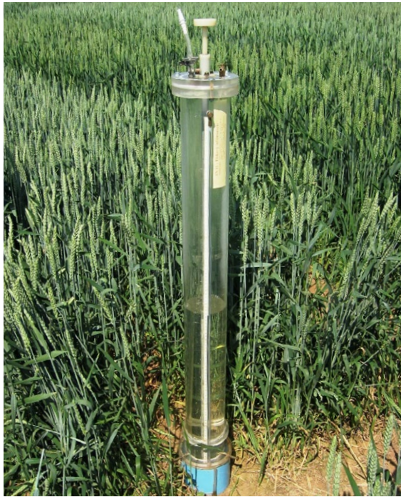
Figure 23 : Grand infiltromètre à tension prédéfinie servant à déterminer l'infiltration de l'eau, ici dans un sol d'un site de grandes cultures. En haut à gauche de l'appareil, on peut voir le tube de dépression muni d'une entrée d'air qui est relié au réservoir d'eau.
