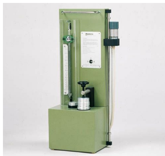
Figure 16 : Pycnomètre à air, disponible dans le commerce, permettant de déterminer le volume solide et liquide d'un échantillon de sol. En utilisant des échantillons de sol séchés et non perturbés dont on connaît le volume total, on peut calculer le volume total des pores. Source de l'illustration : avec l'aimable autorisation de Royal Eijkkelkamp.
