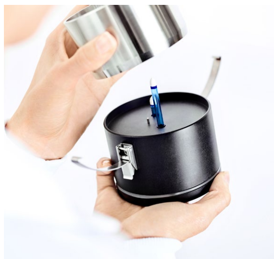
Figure 14 : Dispositif Hyprop 2 pour la mesure du volume de pores dans la plage de force de succion de 0–820 hPa (toute la plage des pores grossiers jusqu'aux pores moyens supérieurs). L'Hyprop 2 permet de mesurer simultanément la courbe de désorption dans la plage de force de succion indiquée ainsi que la conductivité hydraulique non saturée sur des échantillons de sol structurellement non perturbés.
