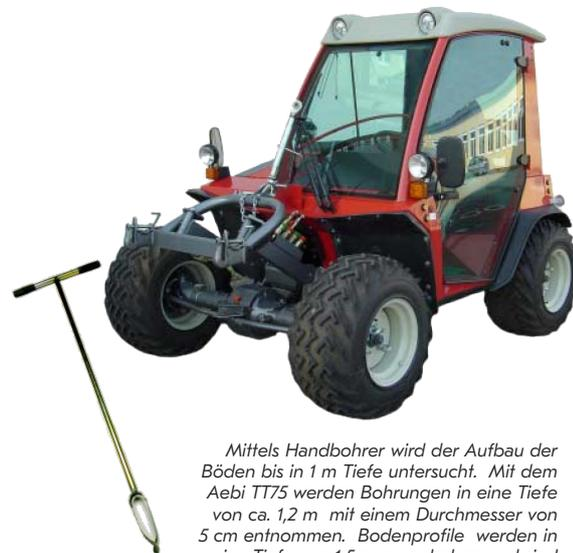
*Mittels Handbohrer wird der Aufbau der Böden bis in 1 m Tiefe untersucht. Mit dem Aebi TT75 werden Bohrungen in eine Tiefe von ca. 1,2 m mit einem Durchmesser von 5 cm entnommen. Bodenprofile werden in eine Tiefe von 1,5 m ausgehoben und sind rund 1 m breit.*
