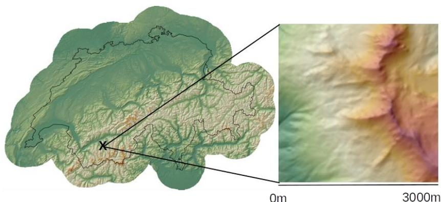
Fig. 2: Modèle altimétrique swissALTI<sup>3D</sup> avec l'extension SRTM de 30 km au-delà de la frontière suisse (à gauche), et exemple de zoom dans une section de terrain (à droite).
